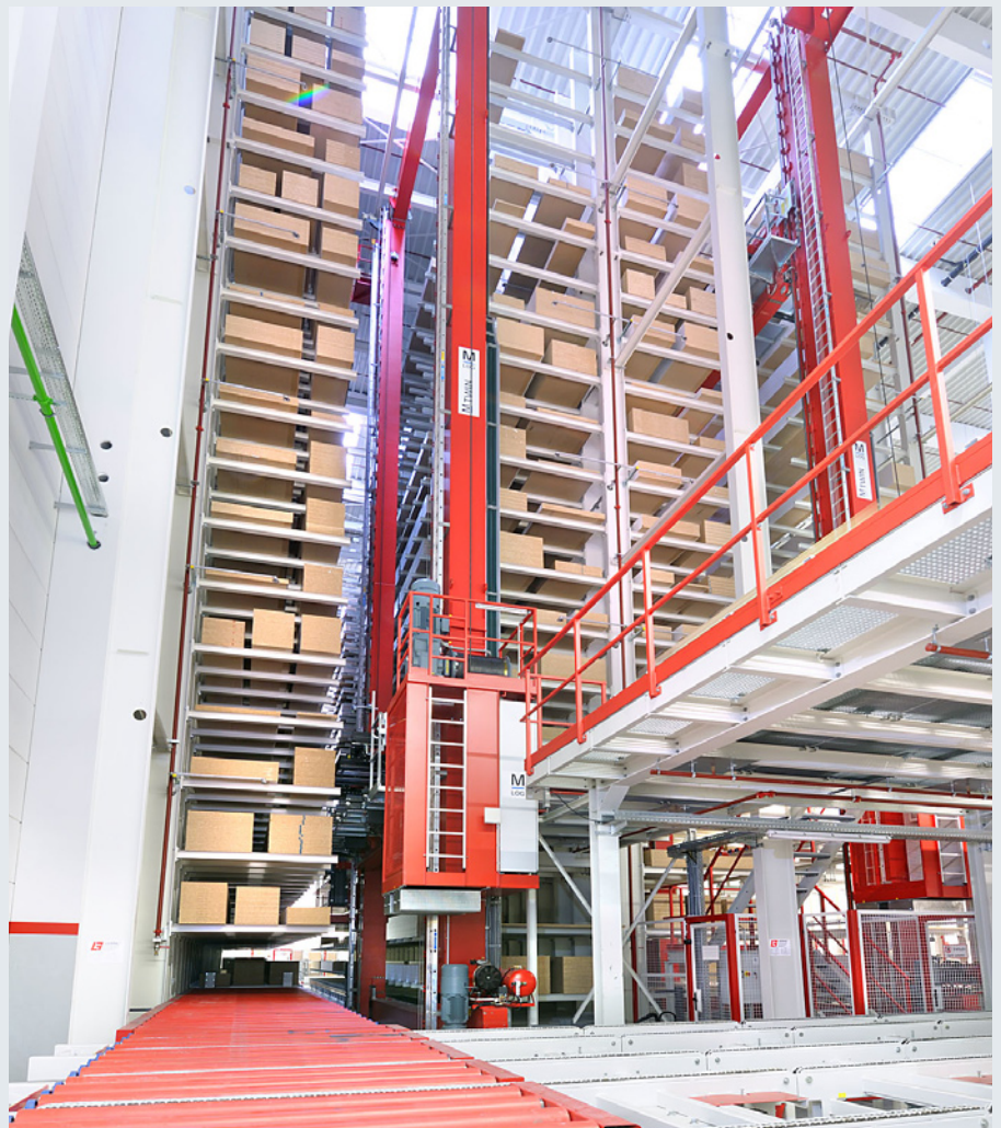
Die 24 Meter hohen MTWIN verfügen über jeweils zwei Säulen und sind daher prädestiniert für die Aufnahme großer und schwerer Lasten. Das Kommissionieren der fast sechs Meter langen Einzelplatten findet direkt auf dem RBG statt.
